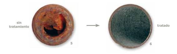
La técnica de impulsos de Vulcan, con su efecto electroforesico, fomenta la formación de una capa metálica protectora de cobre. Esta capa se compone, conforme al material del tubo, de carbonato de cobre, hierro o zinc que se puede encontrar en las superficies relucientes de metal; de esta forma Vulcan protege así toda la tubería del óxido y la corrosión.
