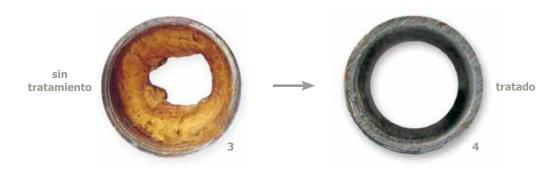
Vulcan impide la formación de nuevas incrustaciones en el tubo. El proceso natural de removimiento de cal solamente tiene que eliminar sedimentos ya existentes. La cal se reduce rápidamente antes de volverse a formar. El tubo queda libre de incrustaciones (fig. 4). El ácido carbónico sólo puede disolver la cal de la cal y no la cal de las paredes internas de los tubos; así permanece una fina capa protectora en los tubos.
